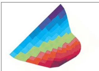
Darstellung der Spannungsbeanspruchung der Dichtung Representation of the stress loading on the seal
