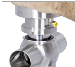
Antrieb um 90° im Uhrzeigersinn drehen und Ventileinsatz herausziehen
